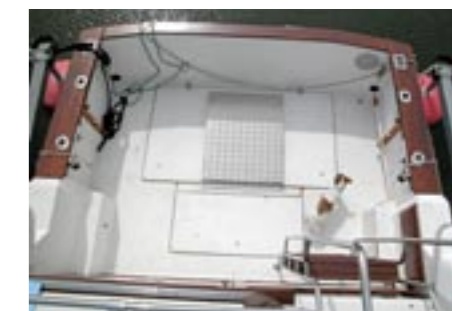
Det från början släta lastutrymmet förstördes med en "aluminiumbula" utan ljudisolering.
