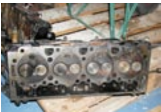
En av de spruckna topparna.
