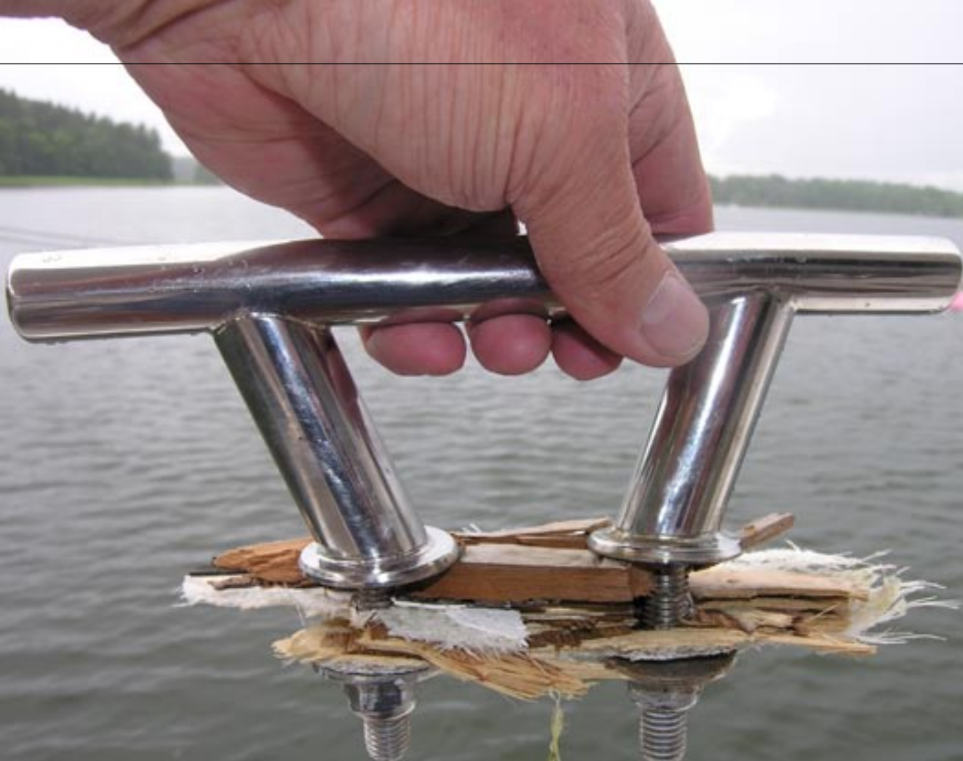
LÖVTUNT LAMINAT. Det räckte med en ordentlig svallvåg vid bryggan och knapen slets loss från däck.
