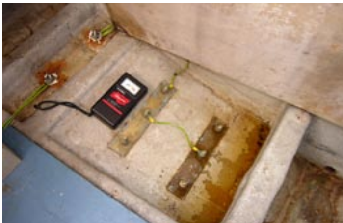
BILDEN VISAR DE INVÄNDIGA FÄSTBULTARNA för stödlagerbocken. Notera färgskillnaderna på bultförbanden och att gelcoaten lossnar.
