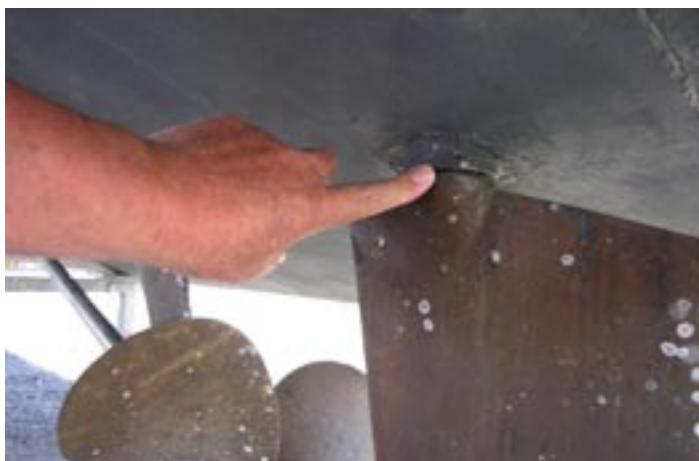
HJÄRTSTOCKSLAGRINGARNA VAR GLAPPA likväl som bussningarna i parallellstaget.
