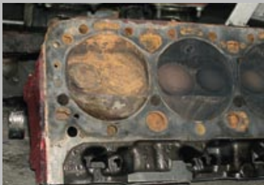
Den roströda färgen från Mälarens vatten avslöjar ett frostsprängt förbränningsrum.
