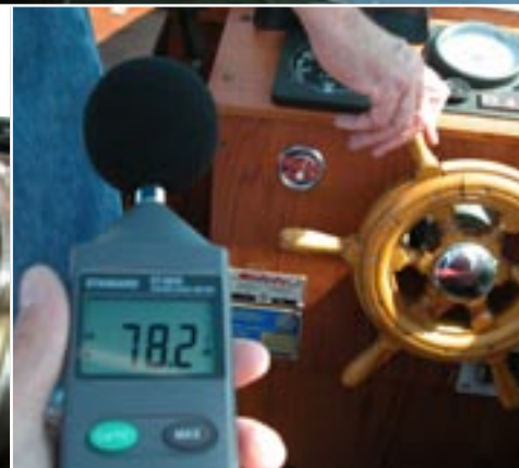
EN FELAKTIGT monterad CV-knut. (nedan) EN TYST OCH FIN MOTOR, 78 decibel A, som kunde varit ännu tystare. (höger)
