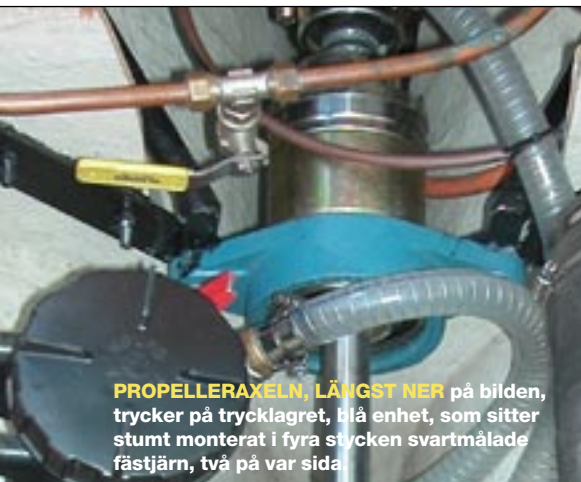
MOTORN VARVADE INTE MER ÄN 3000 RPM på grund av felaktig vald propeller, därmed arbetar motorn för tungt och man tappar cirka 5 hk av toppeffekten.
