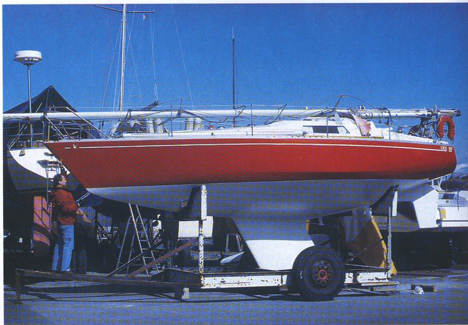
Scampi Mark IV i sin prydno. Skrovet är höjt (ungefär från snobbranden) jämfört med tidigare båtar och 'N' för Norlin finns ingravat i fören. Under vattnet är det mesta sig likt utom rodet som fick övre delen kapad redan från början av Mark IV (något som man numera börjat ändra tillbaka). Båten är Lars Nybergs Röde Orm, se ruta om Scampi-ägare.
