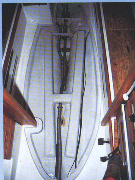
Kölsvinet på en Scampi Mark IV; med motorn i förpiken går propelleraxeln över kölen och mynnar ut akter om denna. Fästet för den utvändiga stödbocken syns mellan stolparna vid navbord och pentry. Den här Scampin har bottenförstärkts med två rejäla, långsgående balkar och en tvärgående balk ovanför kölens bakkant för att skydda mot grundstötningar.
