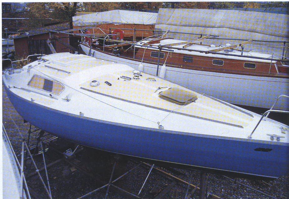
Så här såg de första serietillverkade Scampi-båtarna ut ('Mark II' efter prototypen som var Mark I). Skrovet har det låga fribordet och överbyggnaden framför masten sluttar ut mot relingen som ett valdäck. Lanternorna är infällda i skrovet.
