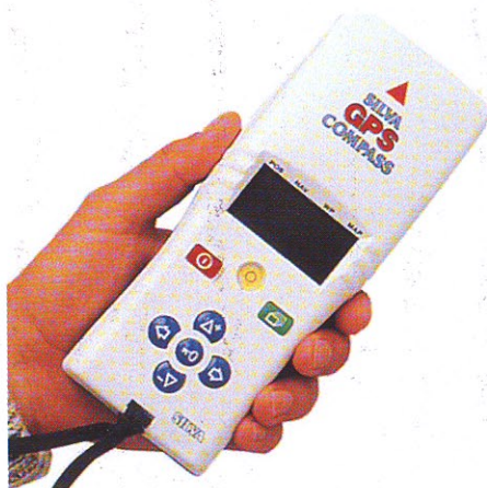
Silvas GPS Compass har måtten 196x80x39 mm, väger 430 gram inklusive batterier, och kan även kopplas till båtens 12 V-system. Det ovanliga med den här apparaten är kombinationen av GPS- och kompass-funktionerna.
