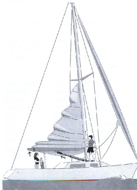
När storen ska beslösas ger kickstången ett säkert och effektivt stöd.
