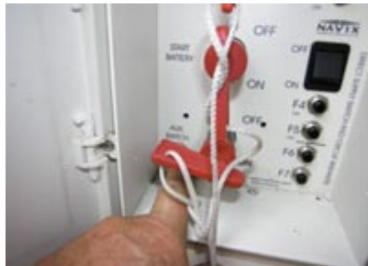
Felkopplad batterifrånskiljare kan vålla stora problem om oturen är framme.
