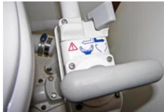
Vattnet stiger i toaskålen därför att backventilen är trasig. Fräscht på toaletten är ett anständigt krav vid båtförväret.
