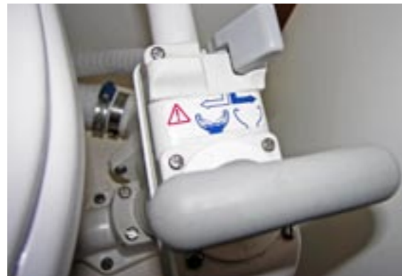
Vattnet stiger i toaskålen därför att backventilen är trasig. Fräscht på toaletten är ett anständigt krav vid båtförvärvet.
