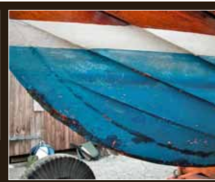
Invändigt i kölsvinet bubblar fernissan på grund av instängd fukt i träet. Det finns särskild kölsvinsfärg som andas. Man ska inte fernissa ett kölsvin, då ruttnar till sist botten.
