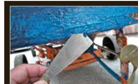
Tjocka färglager, Ettans tätningsmedel och gammal blymönja ger en botten i stort behov av renovering.
