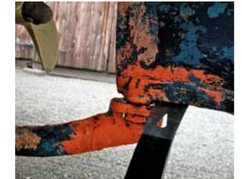
Rodret glappar och det är massor av Ettan, färg och blymönja även här. Tarvar omvårdnad.
