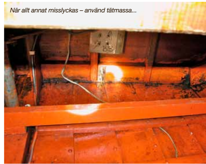
Invändigt i kölsvinet bubblar fernissan på grund av instängd fukt i träet. Det finns särskild kölsvinsfärg som andas. Man ska inte fernissa ett kölsvin, då ruttnar till sist botten.
