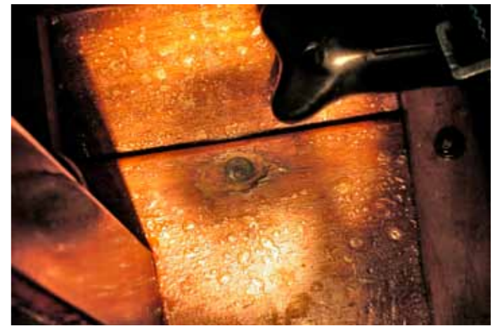
Invändigt i kölsvinet bubblar fernissan på grund av instängd fukt i träet. Det finns särskild kölsvinsfärg som andas. Man ska inte fernissa ett kölsvin, då ruttnar till sist botten.
