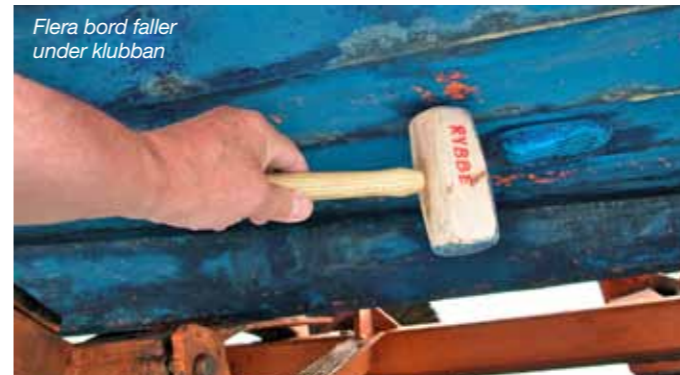
Tjocka färglager, Ettans tätningsmedel och gammal blymönja ger en botten i stort behov av renovering.
