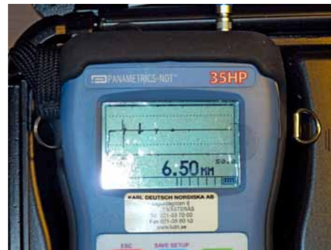
Utrustningen består av ett mätinstrument som visar ekots utformning och mätsiffror i millimeter.
