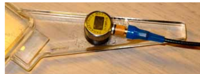
Till den hör en ekolodsgivare och kontaktkräm som du flyttar runt på skrovet.
