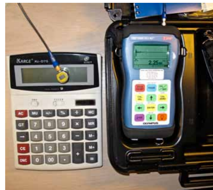
Här visar instrumentet att räknarens plexiglas är 2,25 millimeter tjockt.
