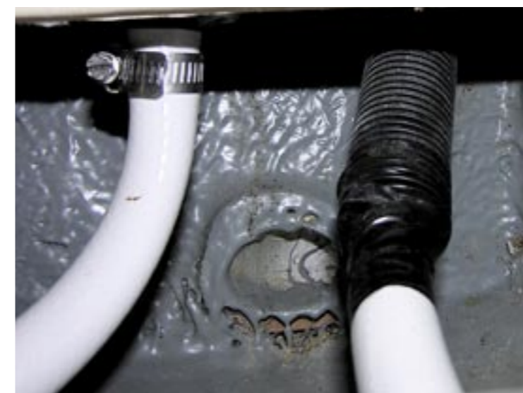
Här ser man anledningen, slangen är skarvad med eltejp.
