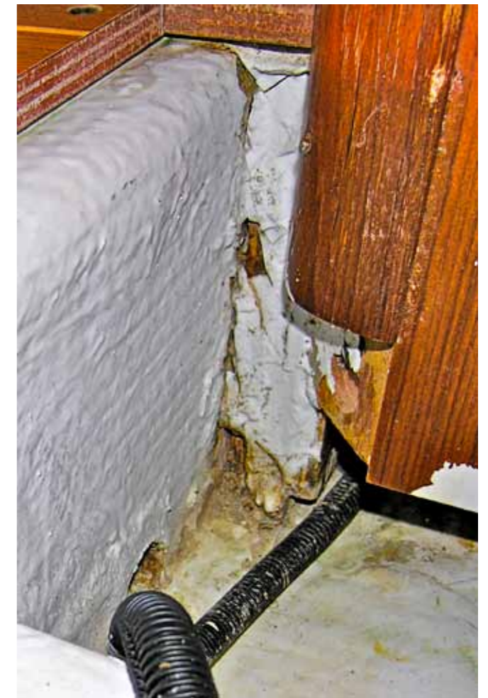
En närbild visar att balk och huvudskott separerat.
