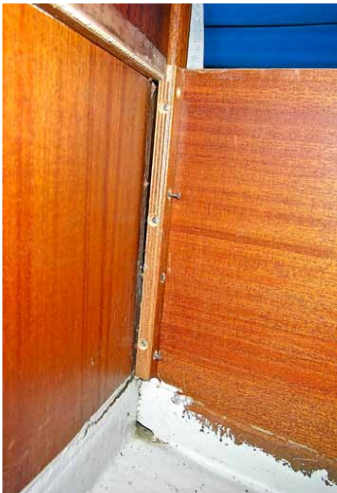
Främre kölpartiet har brutits nedåt, slitit loss huvudskottet och ett längsgående skott.
