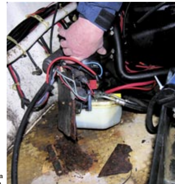
Resterna av- och emulgerad olja från hydraulpumpen för styrbords trimplan.
