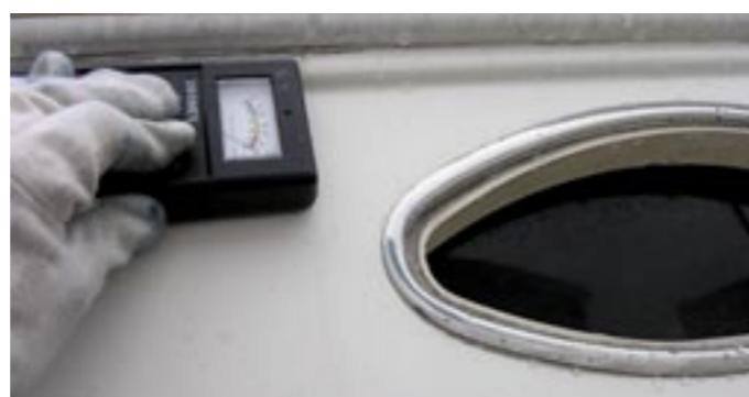
Fuktmätarens nål har passerat skalan på instrument vilket den även gjorde på insidan av skrovet.
