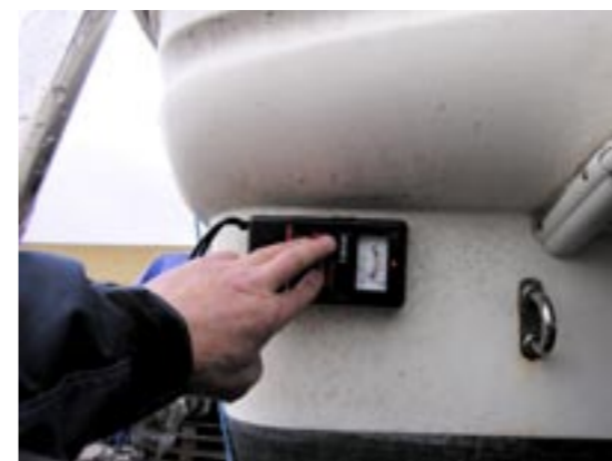
Akterspejeln är blöt långt över vattenlinjen.
