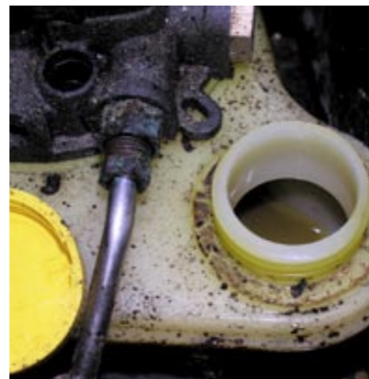
Resterna av- och emulgerad olja från hydraulpumpen för styrbords trimplan.
