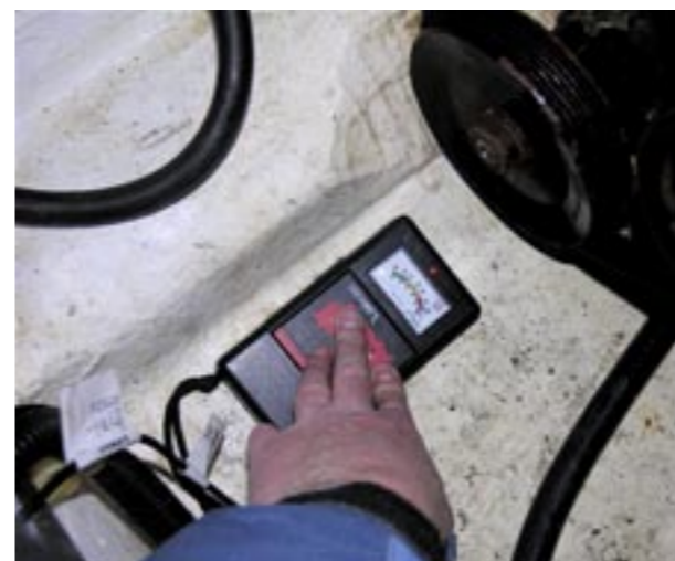
Både botten och bottenbalkar är fullständigt genomdränkta.
