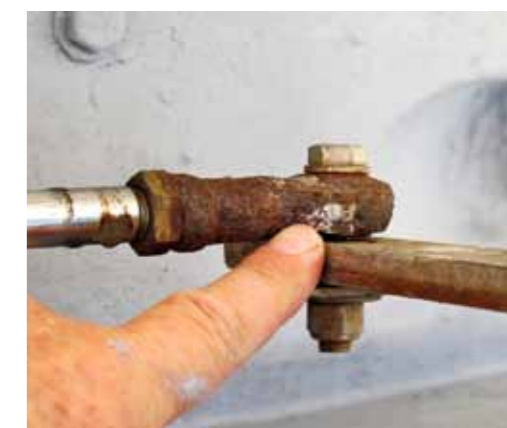
Kulbulten har rostast fast, istället fungerar själva bulten som rörlig led med stort glapp som följd.
