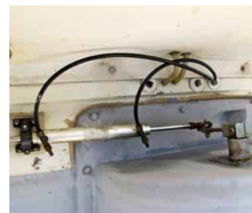
Yttre styrutrustning med en sedan mycket länge fast-rostad kulbult.
