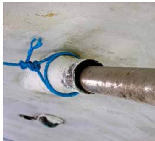
Två stycken ocentrerade propelleraxlar på en 3-miljoners motorbåt från -05.
