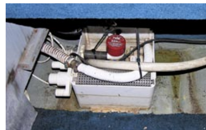
Felkopplade ledningar utan filterfunktion, locket saknas, grävatten rinner ut i köllsvinet, virket ruttar m.m.
