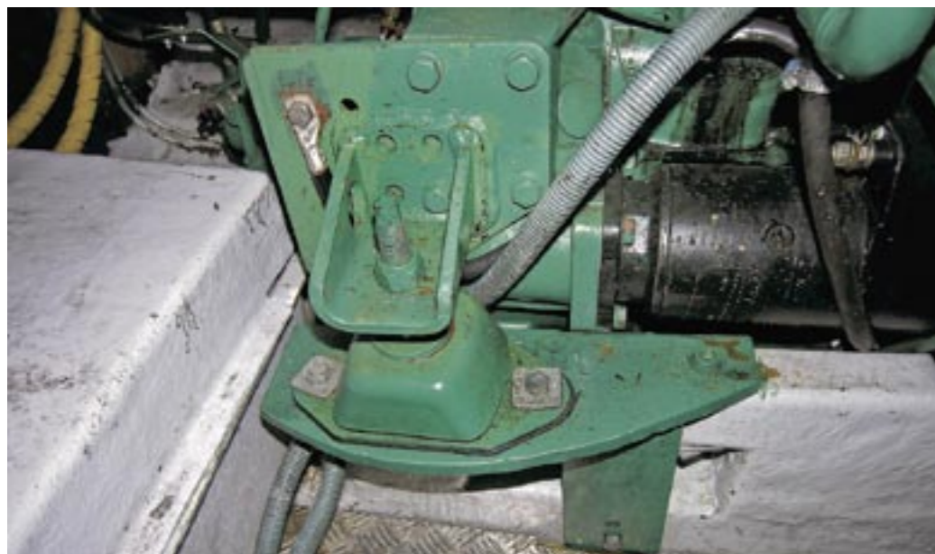
För trång motorbädd har skapat en rejäl amatör-installation med smidesjärn och franska bultar.
