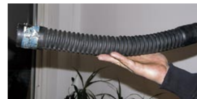
En bilkylarslang av simplaste sort har använts som transport av externt havsvatten vilket föranlett sönderrostad stålspiral.
