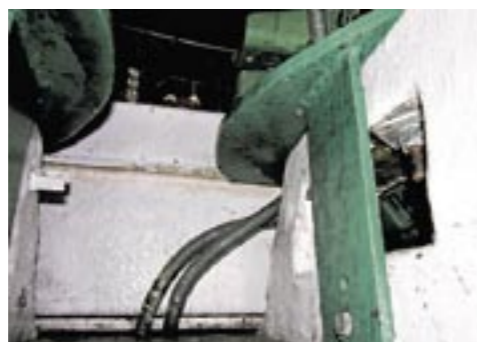
För trång motorbädd har skapat en rejäl amatör-installation med smidesjärn och franska bultar.
