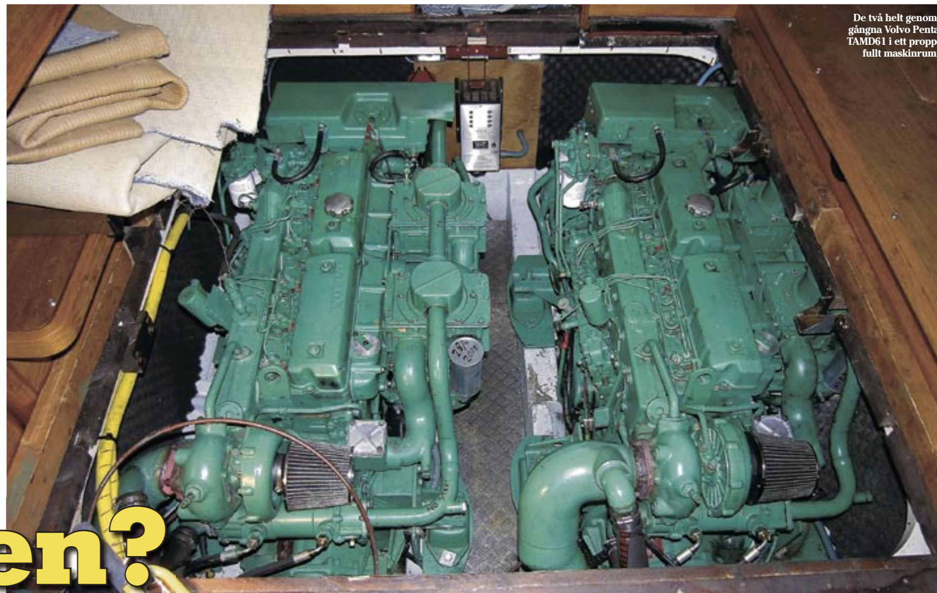
För trång motorbädd har skapat en rejäl amatör-installation med smidesjärn och franska bultar.
