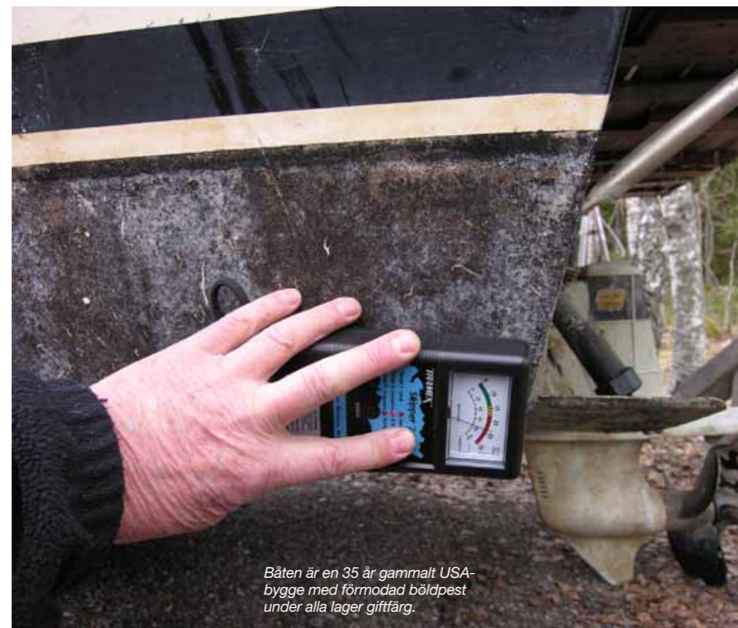
Otåta drevsköldar som läcker in vatten i träförstärkningen långt upp över vattenlinjen.
