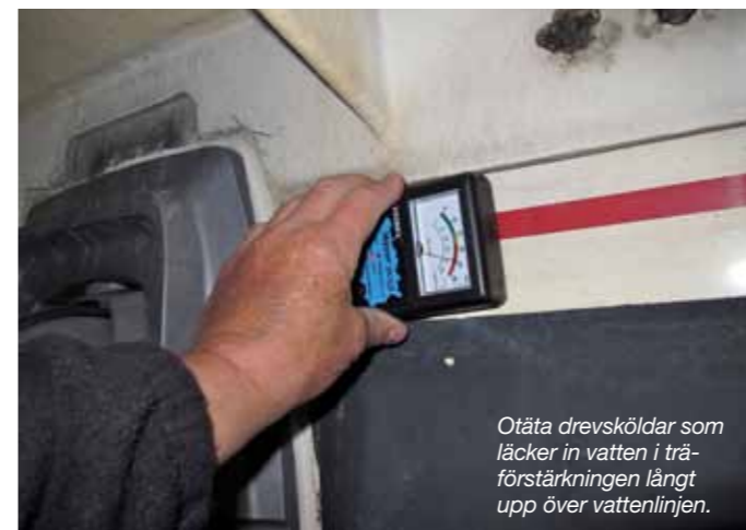
En otät skrovgenomföring har läckt in vatten i sandwichlaminatet.
