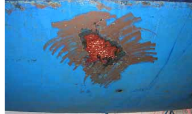
På denna bild ser man vad som döljer sig under alla lager av färg, nämligen ca. 2000 blåsor per kvadratmeter, och som täcker hela båtens botten.
