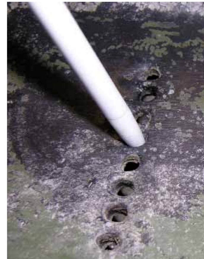
På var sida av drevet finns 8 st hål till vattenintaget med en diameter av 5 mm.
