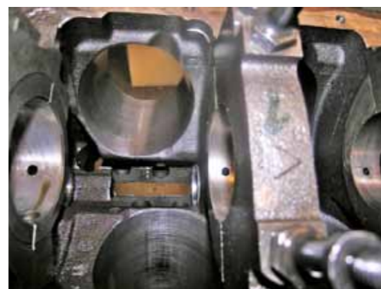
Överförlitna och ovala cylinderlopp.
