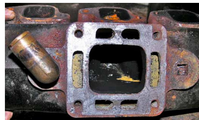
En spricka i avgaslimpan plus packningsläckage avslöjade mera fusk.
