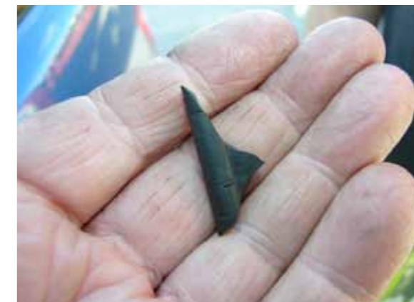
En bit impeller-vinge som "hittades" i vatten-pumpen? Där brukar de inte bli kvar.
