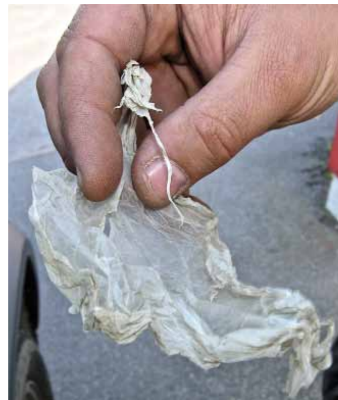
Plastbiten som "hittades" i inloppshålen på riggen.
