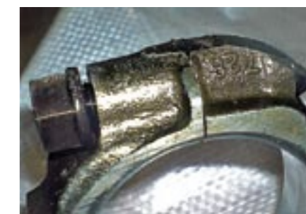
Bilden visar en av de andra åtta vevstakarna. Här syns tydlig att det är slipat för hand, vinkelslip, bänkslipmaskin eller något liknande. Notera att kurvan är annorlunda och djupare. Knappt hälften av bultskallen återstår.
