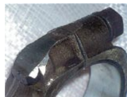
Här syns det tydligare hur man slipat bort stora delar av bultskallen och material från vevstaken. Tala om brottanvisning och obalans.
