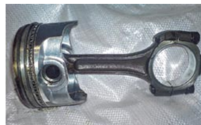
En av kolvarna i de två V8-motorerna. Notera kurvan på den övre bultens skalle till lageröverfallet.
