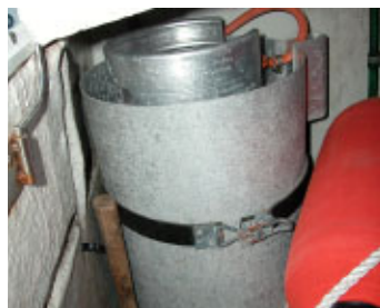
Även en sittbrunnstuv går bra om man har ett separat gasolkärl med bra fallhöjd för gasolrörningen.
