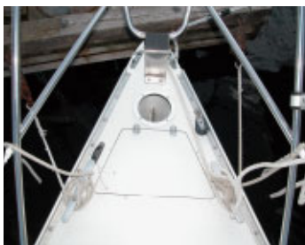
Bra ställe för dränerat gasol-utrymme.
