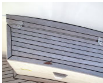
Bra ställe för dränerat gasol-utrymme.
