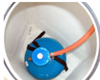
Bäst är ett separerat utrymme under en sittbrunnsbänk.
