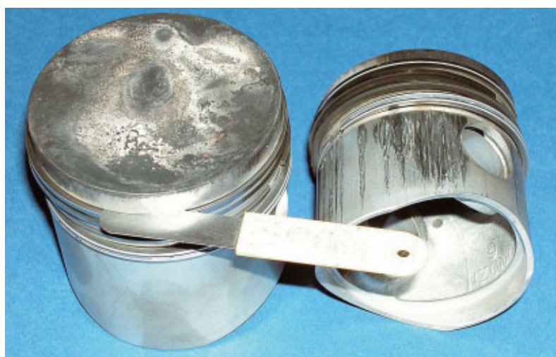
Den vänstra kolven är oskadad men sliten i kolringsspåret, den högra har tydliga skärskador efter överhettning.
