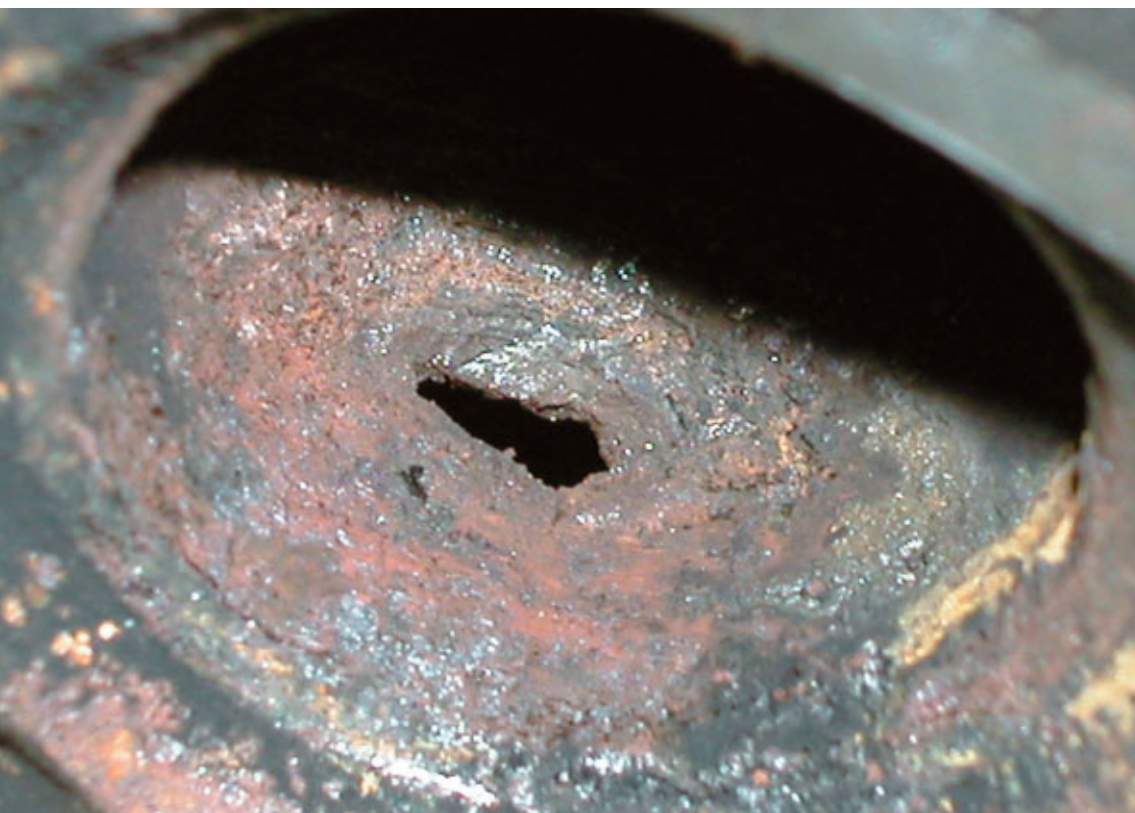
Så här går det när det kommer in vatten i cylinder, det blir totalhaveri.
