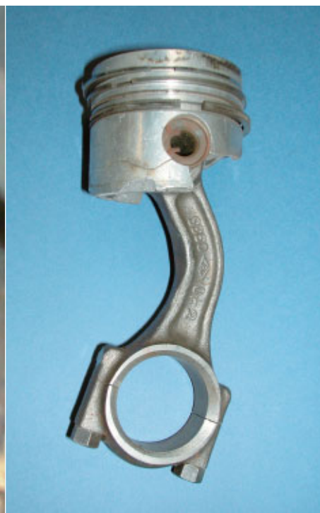
Så här går det när det kommer in vatten i cylinder, det blir totalhaveri.
