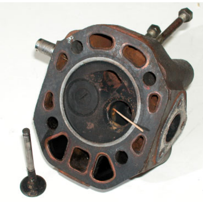
Även om topplocket skall bytas ut, så är det intressant att studera effekterna av 25 års slitage. Här blev felet uppenbart redan vid demonteringen av avgasventilen, rosthål från kylkanalen till avgaskanalen.
