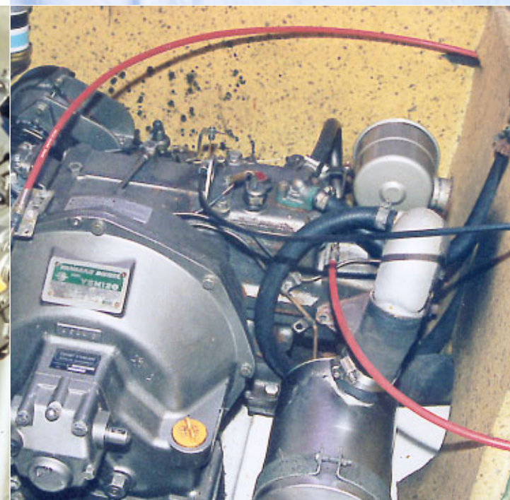
Motorn sedd akterifrån, cylindern till höger. Topplocket skall demonteras av åt höger, med andra ord knepiggt, men det går. Mer om detta i kommande nummer.
